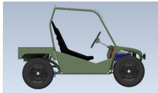
Gambar 4 Design 3D pada Wikan Electrical Tactical Vehicle (Tampak Samping) (Sumber: Diolah oleh Peneliti)
