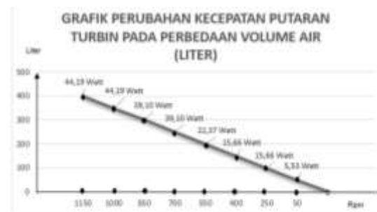
Gambar 3. Perubahan kecepatan putaran turbin pada perbedaan volume air
