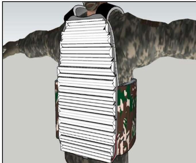
Gambar 4 Desain rompi tampak dalam dengan susunan tembaga touch sensor
